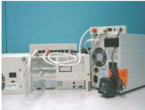
图表2-20 从USHA ProE II的「局域网」端口连接以太网网络电缆
