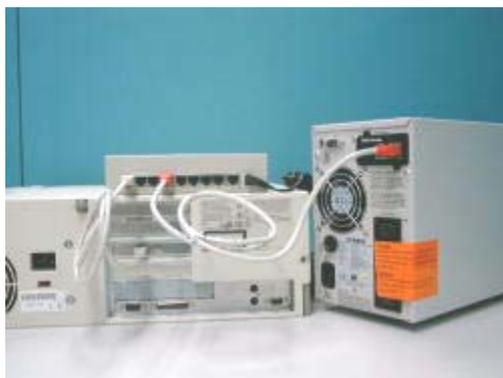
图表2-19 从USHA Card 的「局域网络」端口连接以太网网络电缆
